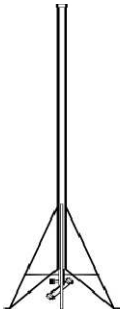
Torre Hidroneumática Clásica
